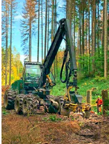
Der Harvester Timberjack 1470 mit einem Ernteaggregat H270 beim Käfereinsatz
