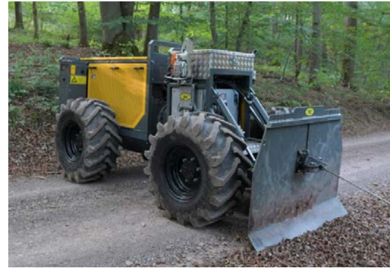
Das hydraulische Polterschild hilft beim Ziehen starker Bäume.
